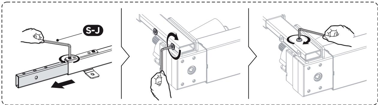
2. Fixe a barra telescópica (A) nas colunas de elevação (B/C) usando 4 parafusos (S-D) e 2 parafusos (S-B), conforme ilustração.
