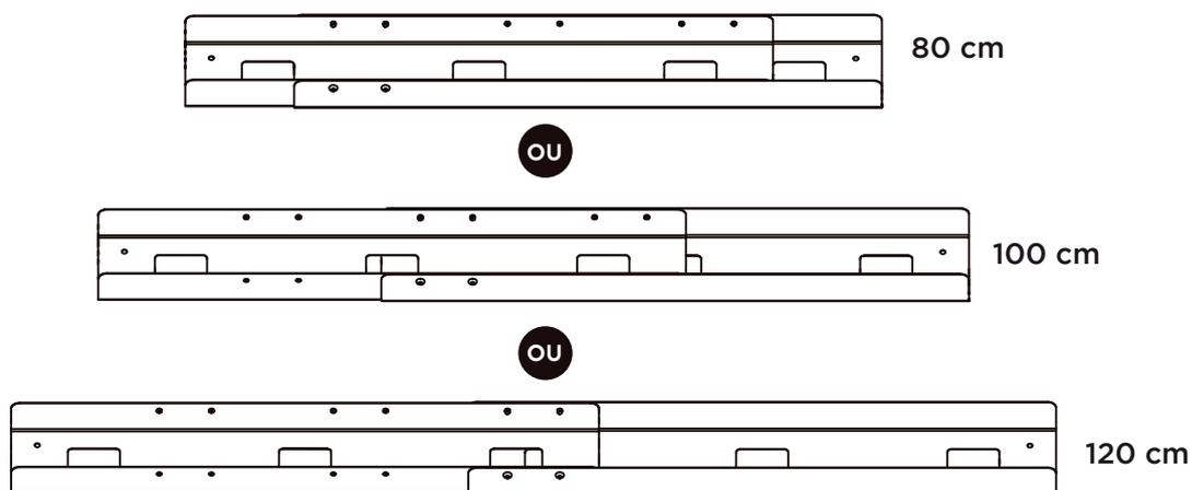
Após selecionar a largura e alinhar os furos, fixe com 4 parafusos de fixação (D).
