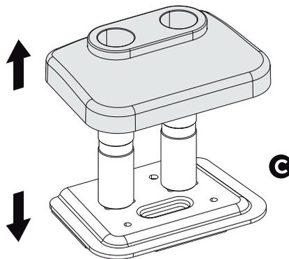
E desparafusando o grampo de pressão F completamente.
